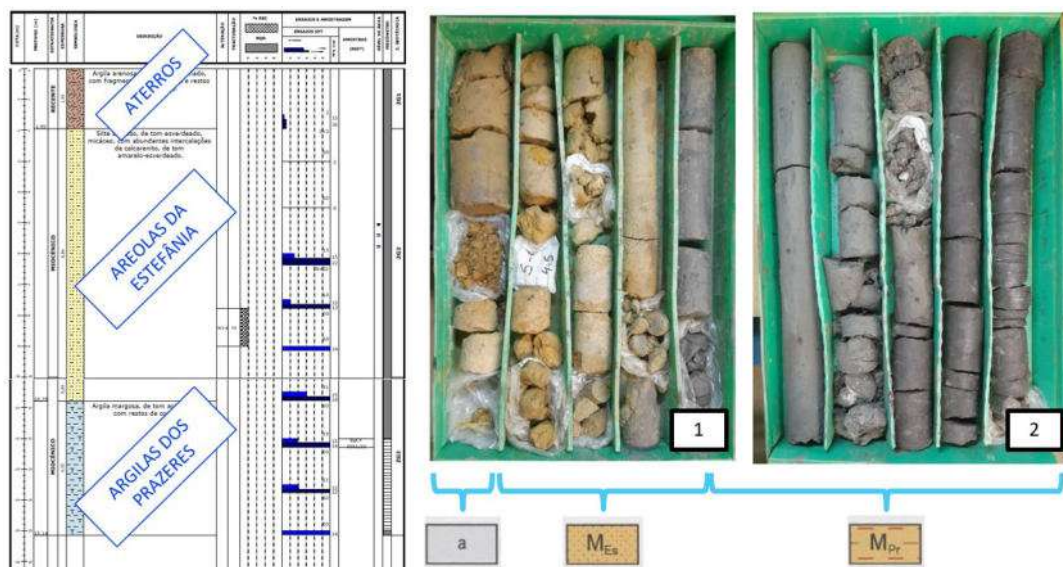
Figura 4 –Extrato do Log da Sondagem S1 (Esquerda) e Respetivo Registo Fotográfico (Direita).
