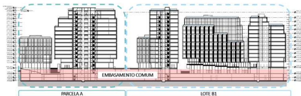
Figura 7 – Corte longitudinal da Parcela A e Lote B1 (embasamento comum a vermelho).
