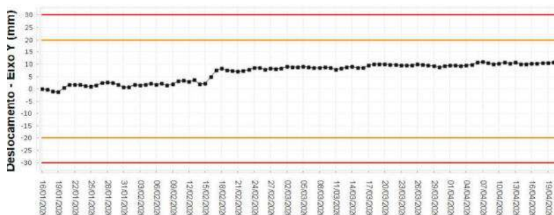
Figura 11 – Deformação horizontal para o prisma localizado na zona de Berlim provisório com 8 m de altura de escavação.
