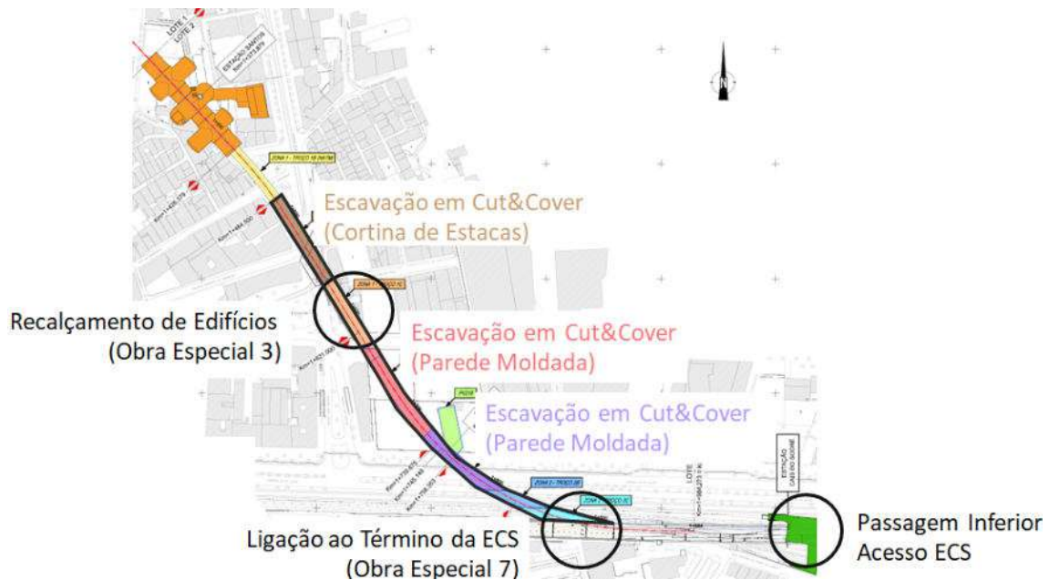
Figura 1. Troço de túnel com escavação em Cut&Cover.
