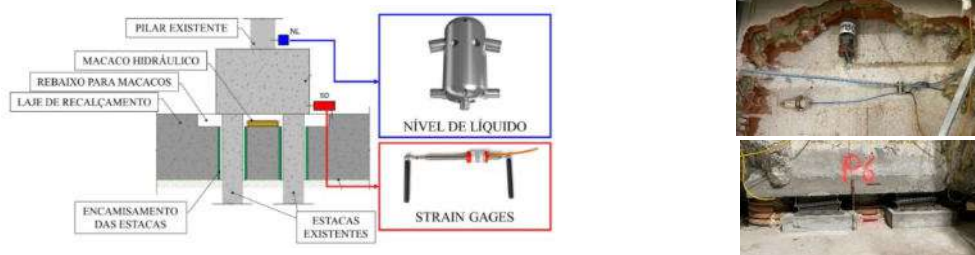
Figura 17. Dispositivos de controlo: Sensores de nível de líquido e extensómetros
